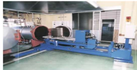
加硫釜自動投入排出装置
